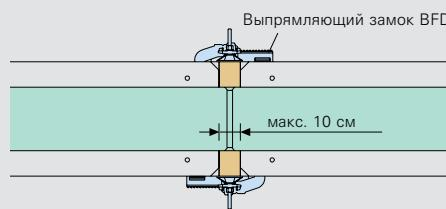
Самое простое и самое быстрое решение при зазоре до 10 см - это использование брусков в сочетании с выправляющим замком BFD.
