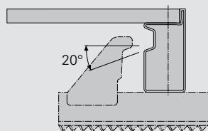
Непрямой угол захвата рамы элемента - характерная особенность замка BFD. Он обеспечивает подходящее направление силы при растяжении.
