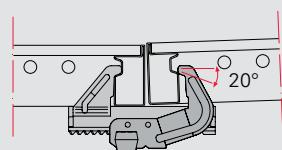
Хорошо продуманная конструкция и механика гарантирует заранее определенный порядок действия выпрямляющего замка BFD: сначала установить заподлицо...
