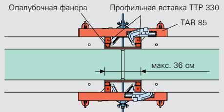
Для выполнения конкретных архитектурных требований, корректировка длины от 20 см до 36 см выполняется с заполняющим профилем TTP 330, а на толщину в 21 мм с обшивкой опалубки.
