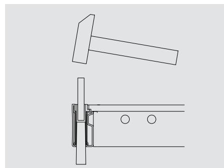
Залитые бетоном анкерные отверстия можно освободить одним ударом молотка благодаря конической форме отверстий.
