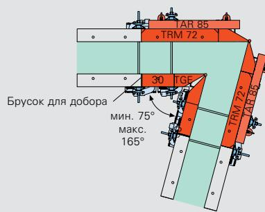
Стандартные углы выполняются с использованием внутреннего угла TE. Толщина стенки от 18 см до 40 см может формироваться непрерывно. В случае необходимости, используется выпрямляющее устройство толщины стенки WDA 5/6.
