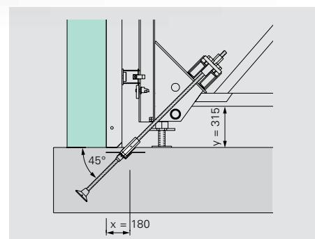
Выбор наиболее подходящей анкерной системы определяется нагрузкой в местах анкеровки опорных рам.
