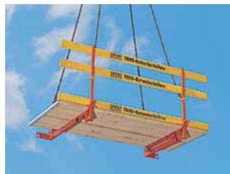
Платформа для бетонирования TRIO 120 x 270 поставляется уже в собранном виде. Она устанавливается сверху на элемент и автоматически закрепляется. Допустимая нагрузка - 150 кг/м<sup>2</sup>.
