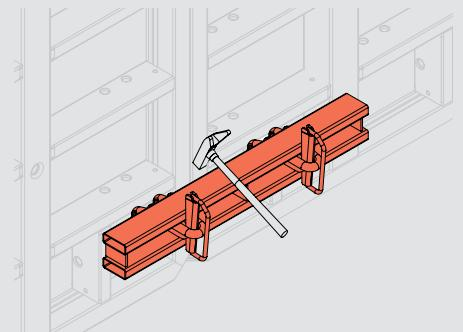
Быстрая установка: крючки просто вставляются в соединительные отверстия на панели, и клинья впоследствии забиваются надежно в определенное положение.
