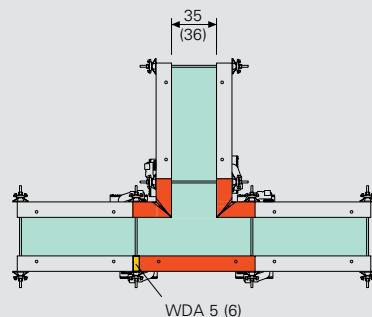
Любая другая общая толщина стенки может легко адаптироваться с помощью выправляющих устройств через 5 или 6 см, путем использования выправляющих устройств через 5 или 6 см, путем использования выправляющих устройств толщины стенки WDA.
