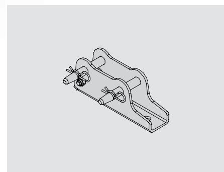
Опорная плита крепится к бетону, например, используя анкерные болты PERI. Два болта опорной плиты используются для соединения подкосов и распорок.
