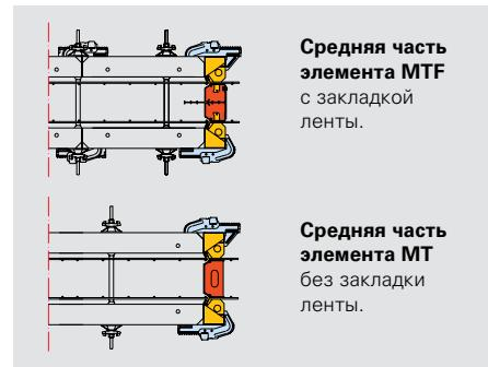
Временные опалубочные элементы с деревянным бруском и заполняющими листами: на лицевой стороне стена опалубливается вместе с выпрямляющим запором. Временная опалубочная связь передает нагрузку на рамную опалубку.
