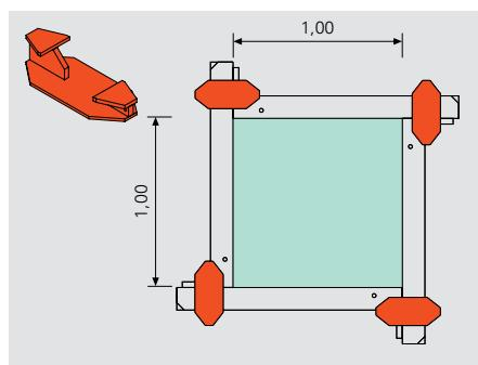
Накладка для фундамента TRIO используется для формирования индивидуальных фундаментов, используя конфигурацию «Ветряная мельница». Размещение плит может фиксироваться с помощью гвоздей.
